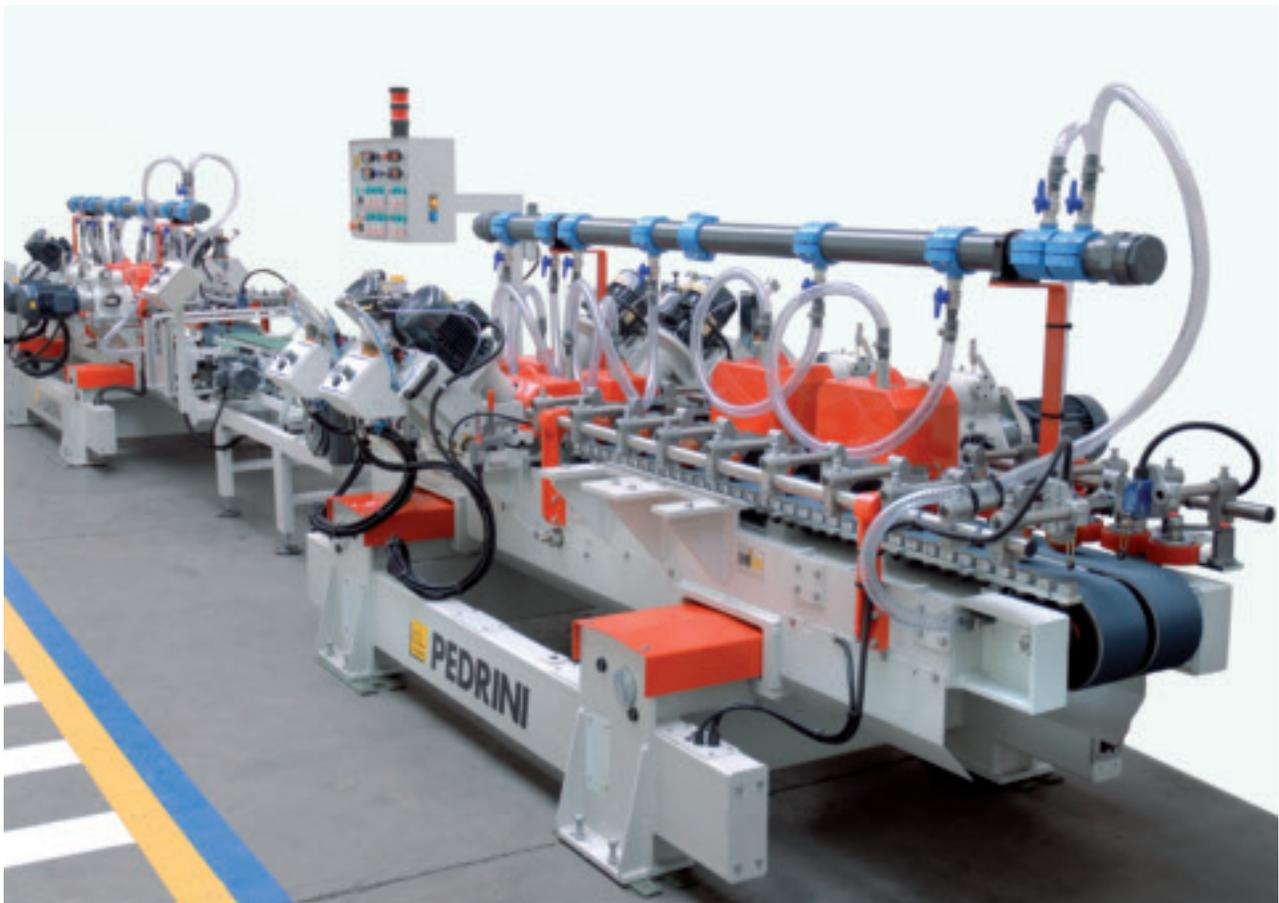
**U**na serie di pressori trasversali posiziona le marmette contro la guida di riferimento che le mantiene allineate dall'entrata fino alle teste bisellanti, mentre una serie di pressori verticali mantiene le marmette solidali ai nastri trasportatori senza slittamento.
