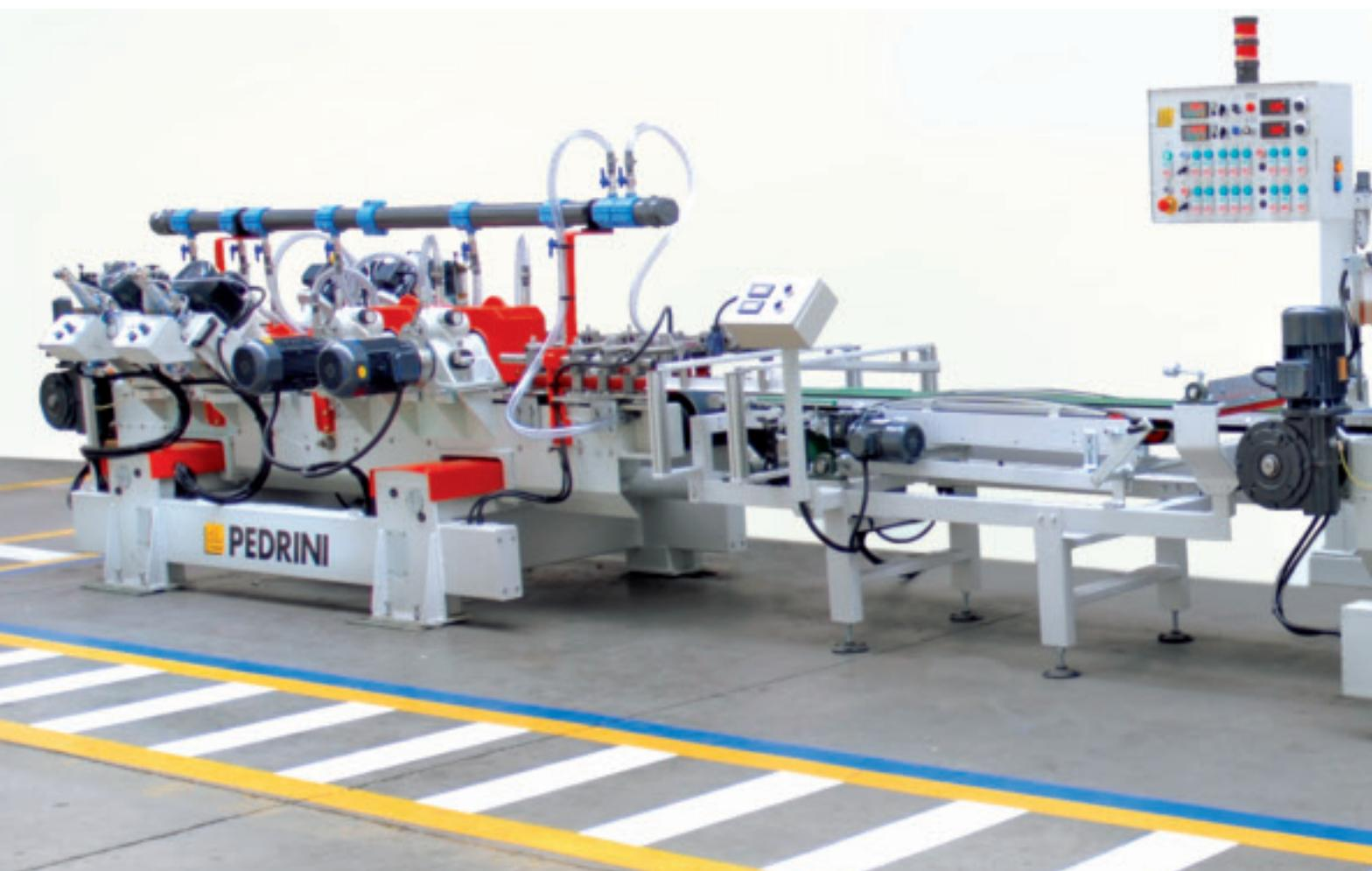
In ciascuna sezione della macchina, precisione di calibratura ed alta qualità dei biselli sono assicurate dalla considerevole distanza tra teste calibranti e teste bisellanti che permette l'esecuzione delle due lavorazioni sulla stessa marmetta in tempi differiti.
