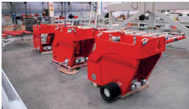
Gruppi di ruote di contrasto pre-caricate sono posizionati tra il carro portadischi, il ponte e le traverse di scorrimento laterale in modo da assicurare una compattezza tra le parti mobili.
