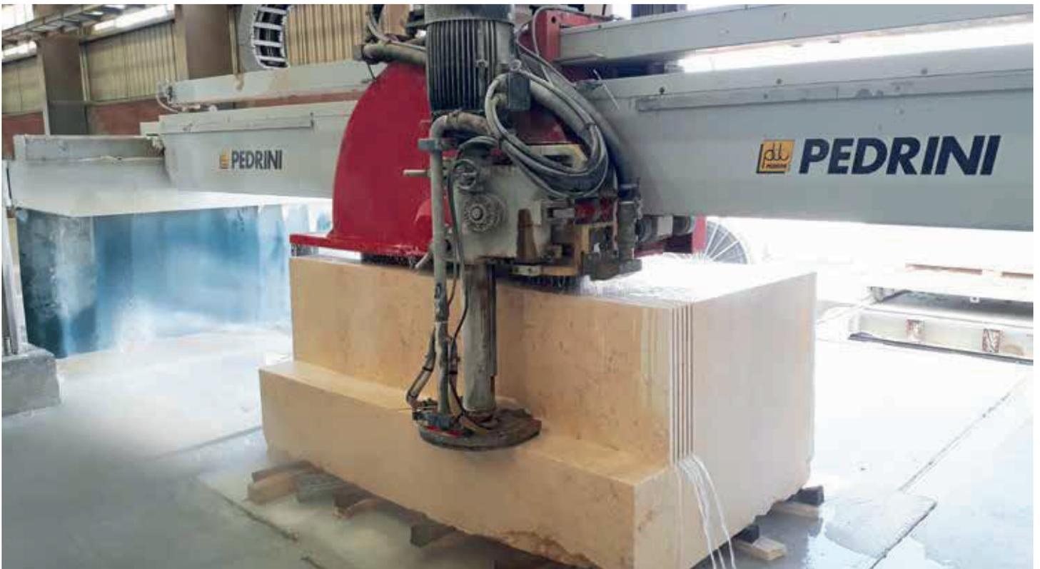
La semplicità costruttiva, la facilità di uso e la flessibilità di ogni singolo modello della M586 consentono un agevole e veloce cambio e sostituzione dei dischi diamantati.
