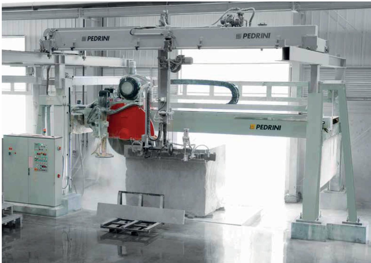
Le 4 colonne che determinano il movimento dell'asse Y per la salita e la discesa, vengono fissate alle fondazioni e sono collegate sulla parte superiore da tre traverse. Due nervature laterali permettono di avere la parte frontale aperta per agevolare l'uso dei vari sistemi di scarico delle filagne e l'eventuale carico del blocco direttamente dentro la macchina, sul piano del pavimento.
