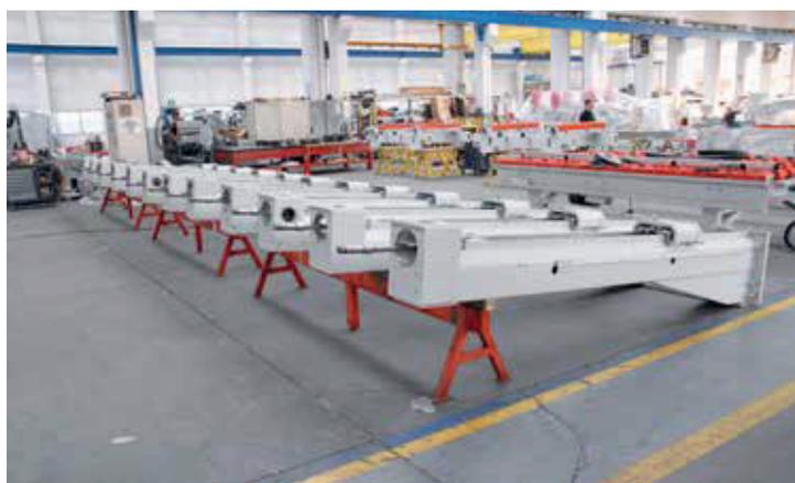
Il movimento del ponte sull'**asse Z da destra a sinistra** avviene su due traverse fissate ai corsoi di salita-discesa. Nella parte superiore delle traverse è ricavato il piano di traslazione del ponte che scorre su una gabbia a rullini antiusura per agevolare lo scorrimento laterale.
