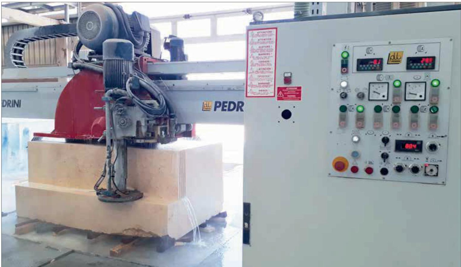
Nella versione MG, la M586 è equipaggiata con il ciclo automatico "a passate multiple" per il taglio di materiali particolarmente duri che viene gestito da un apposito PLC.
