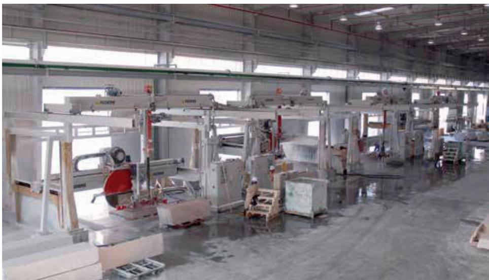
La tagliablocchi M586MS monta dischi verticali con un diametro massimo di 1600 mm e può tagliare filagne di altezza massima di 610 mm. Un'ampia gamma di modelli caratterizzati da un motore di diversa potenza permette di scegliere il sistema più adatto per il taglio dei vari materiali.
