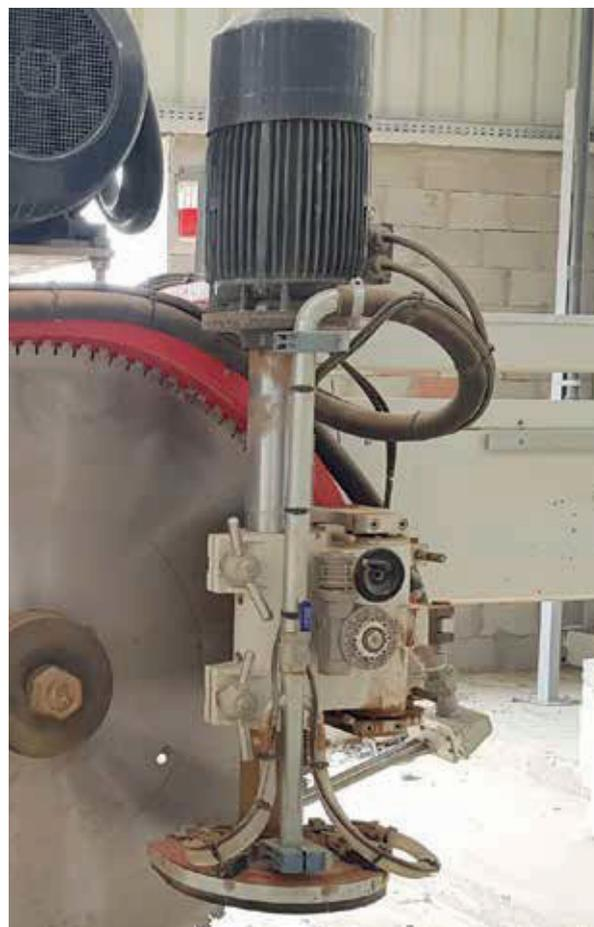
Un sistema di distribuzione dell'acqua di lubrificazione molto razionale e facilmente ispezionabile provvede alla refrigerazione dei dischi diamantati.
