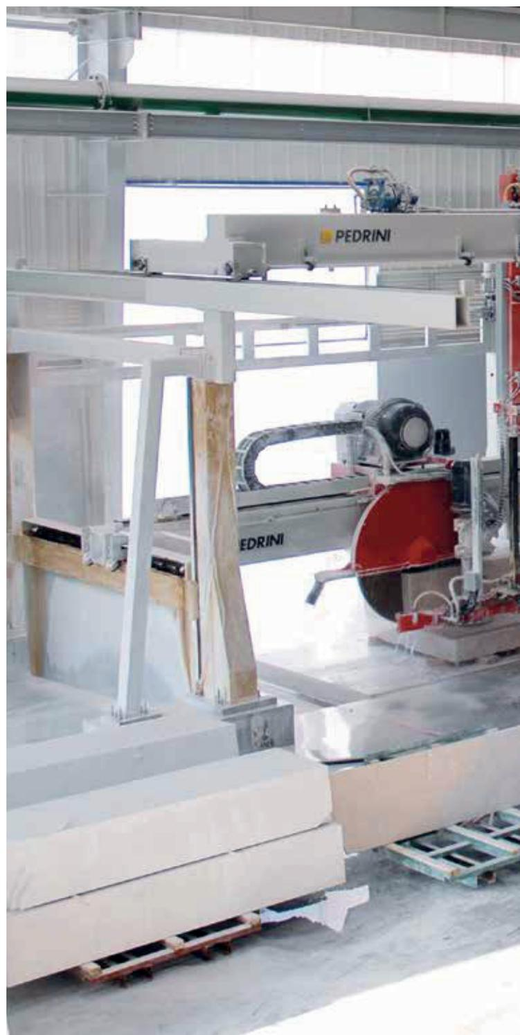
La M586 è una macchina con la classica struttura a 4 colonne e lavora a blocco fermo. Disponibile in vari modelli può soddisfare le esigenze di ogni singolo cliente.
