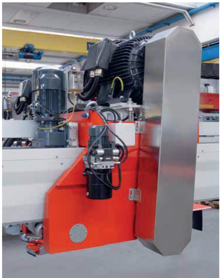
Il quadro elettrico principale di grandi dimensioni è posizionato a bordo macchina ed è protetto contro polvere e spruzzi d'acqua secondo IP 54. Il pannello di comando è montato direttamente sul quadro elettrico e permette la programmazione e visualizzazione dei parametri di lavorazione.
