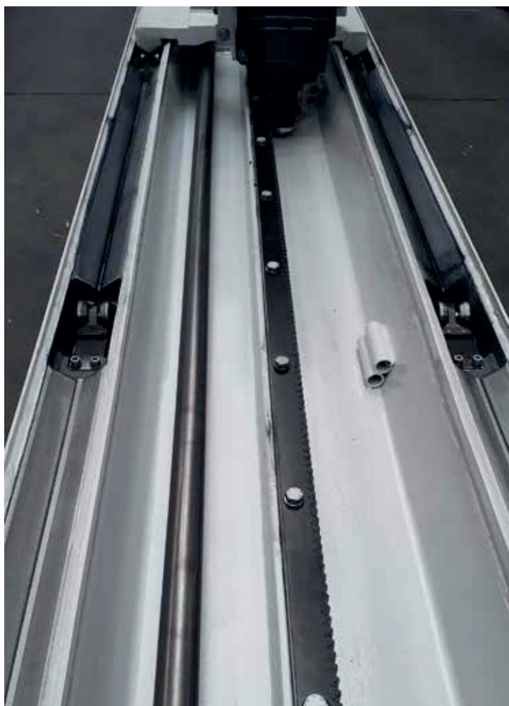
Il carro portadischi è realizzato in fusione di ghisa ed è azionato da un sistema motoriduttore/pignone/cremagliera.
