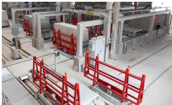
IT Butterfly B416 con carico/scarico su carrelli motorizzati di logistica interna motorizzata. EN Butterfly B416 with loading/unloading on customized internal-logistic motorized trolleys .
