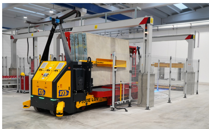
IT Butterfly B416 con carico/scarico su cavalletti mobili da 35 ton per movimentazione con LGV . EN Butterfly B416 with loading/unloading on 35 ton mobile slab holder stands for LGV handling.
