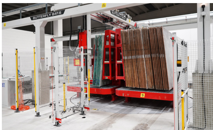
IT Butterfly B416 con carico/scarico su cavalletti mobili da 35 ton per movimentazione con LGV . EN Butterfly B416 with loading/unloading on 35 ton mobile slab holder stands for LGV handling.
