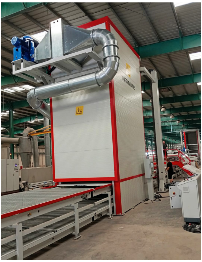
TORRE DI ASCIUGATURA DRYING TOWER
