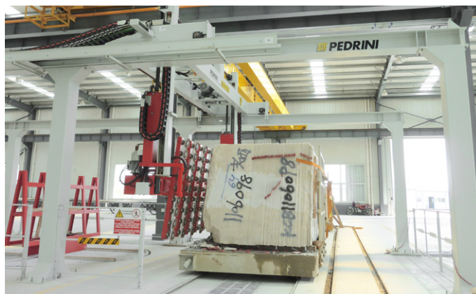
IT Butterfly B416 con presa diretta dai carrelli delle multifilo o dai telai da marmo. EN Butterfly B416 with direct loading from multiwire trolleys or marble gangsaw trolleys.
