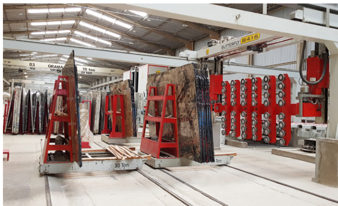
IT Butterfly B416 con carico/scarico su carrelli motorizzati di logistica interna motorizzata. EN Butterfly B416 with loading/unloading on customized internal-logistic motorized trolleys .
