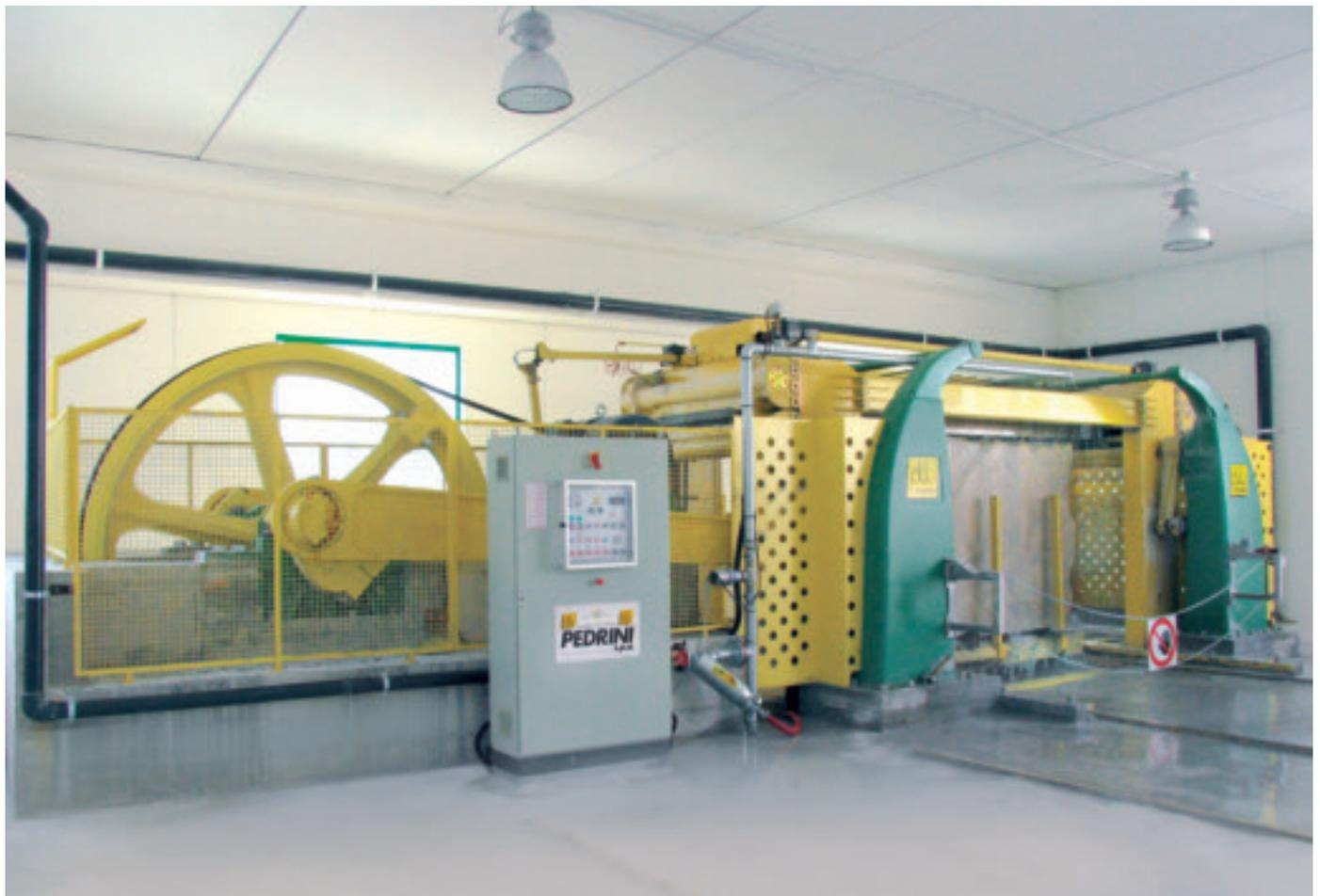
■ Il castello, realizzato in carpenteria pesante normalizzata, è costituito da una struttura composta estremamente rigida e che permette di utilizzare il pacco lame alla massima tensione.
