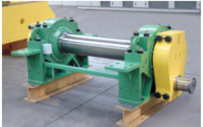
■ Il gruppo della batteria è stato generosamente dimensionato a partire dall'albero del volano che nella versione a 30 lame ha un diametro di 220 mm e nelle versioni a 40 e 50 lame è stato realizzato con diametro di 260 mm.
