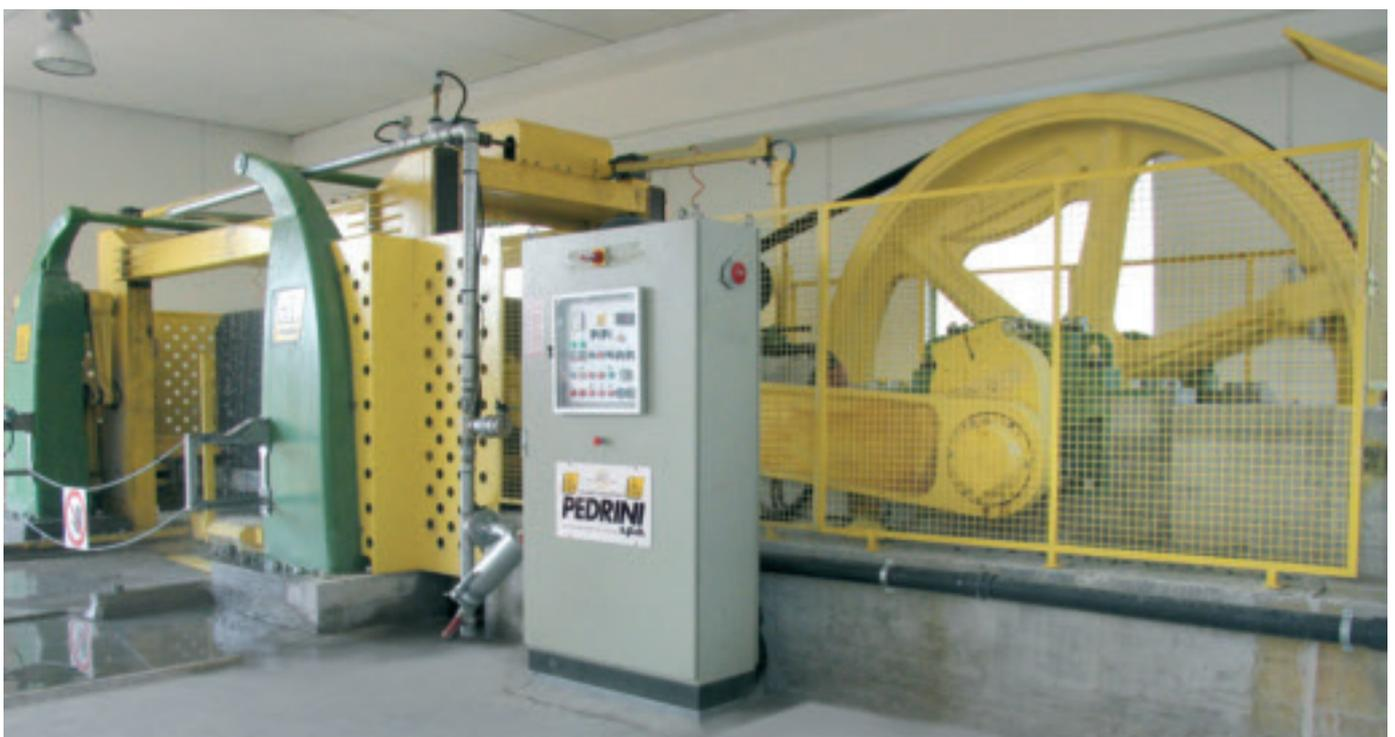
■ Il bloccaggio del carro portabloccchi, installato sulla parte fissa della macchina, toglie lo sforzo di taglio dalle ruote eliminando ogni causa di vibrazione.
