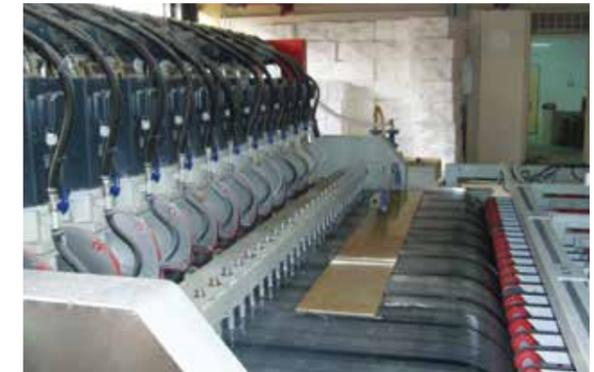
Un gruppo di sensori montati all'entrata della macchina individua l'inizio della filagna in modo che la posizione del primo disco si trovi in corrispondenza con il primo taglio.
