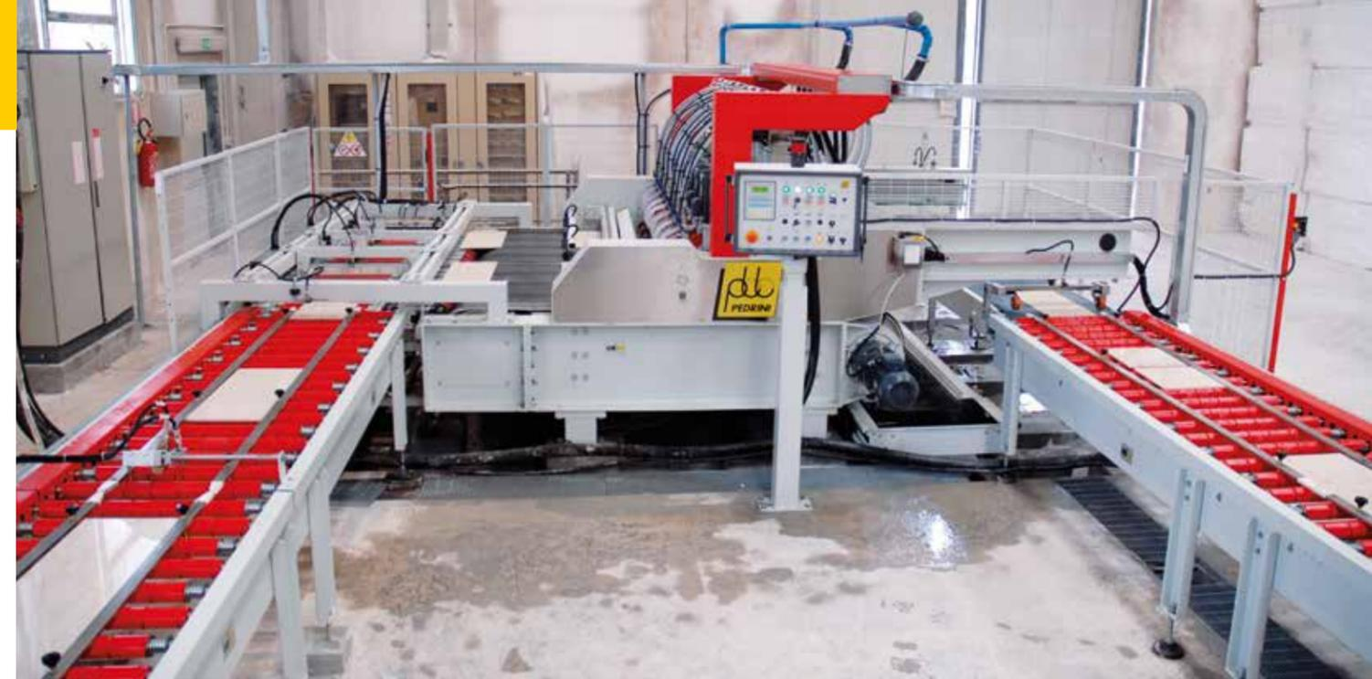
Un gruppo di sensori montati all'entrata della macchina individua l'inizio della filagna in modo che la posizione del primo disco si trovi in corrispondenza con il primo taglio.
