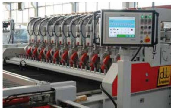
La potenza dei motori delle teste dipende del materiale e dello spessore lavorato.
