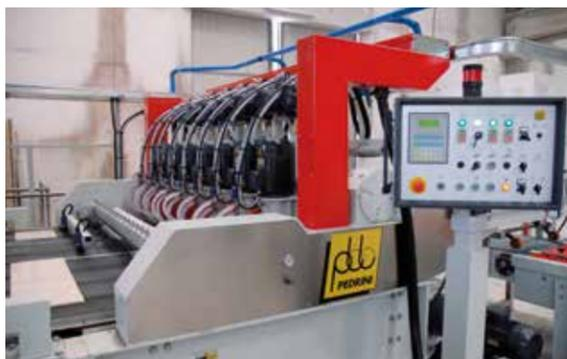
Sistema di movimentazione delle teste motorizzato gestibile dal pannello di comando.
