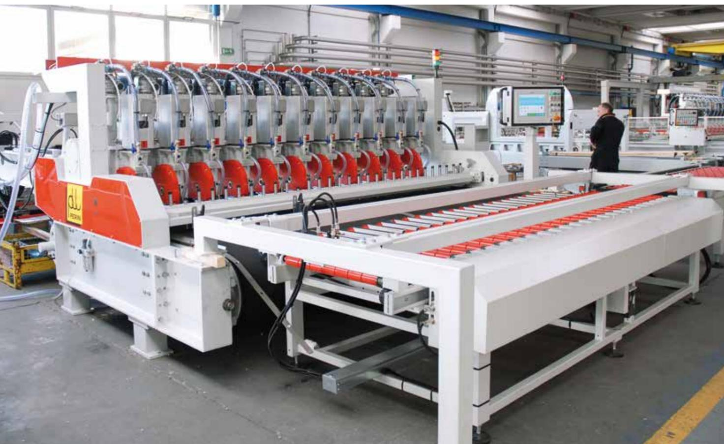
Le teste sono montate e scorrono sulla trave di grosso diametro rettificata e cromata e vengono mantenute ferme nella posizione di lavoro da sistemi di bloccaggio pre-caricati.
