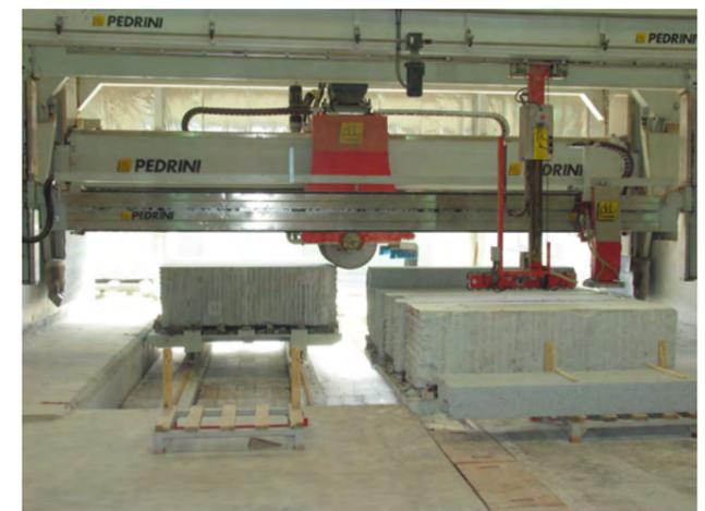
Sull'Arco di Trionfo vengono installati una serie di dischi diamantati il cui numero e diametro variano in funzione dell'altezza e dello spessore delle filagne che si vuole tagliare.
