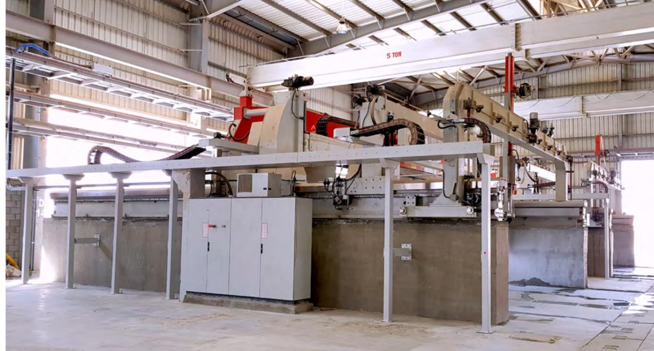
Tutti i motori di movimento sono controllati da inverter vettoriali e la precisione dei posizionamenti è assicurata da trasduttori digitali di posizione (encoder).
