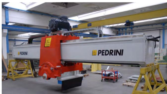
Sulla parte superiore del ponte sono ricavate le esclusive **doppie guide a "V"** che permettono lo scorrimento della slitta del carro portadischi lubrificata di continuo a bagno d'olio.
