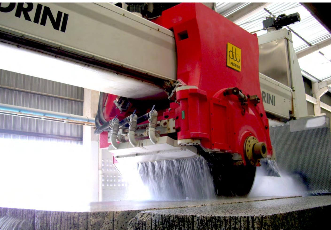
**Il carro portadischi alloggia un insieme di importanti componenti elettrici e meccanici:**
