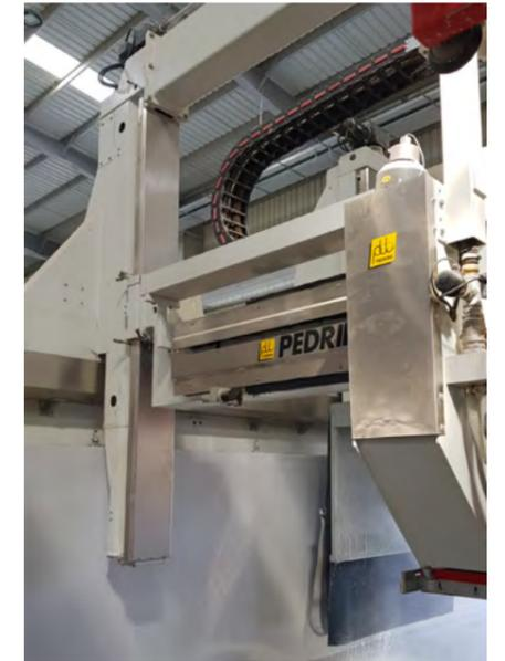
I due movimenti di traslazione e di salita e discesa, composti rispettivamente da due motori collegati fra loro da un insieme di alberi e trasmissioni angolari, permettono di muovere i due assi in perfetta sincronia.
