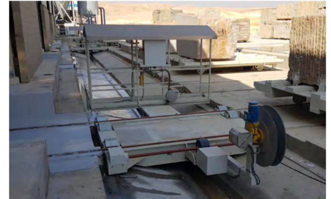
Il carrello viene movimentato da un motoriduttore, fissato nella parte inferiore, che ne permette il movimento fluido su binari speciali posizionati con perfezione per avere uno scorrimento lineare quando il carrello è a pieno carico.
