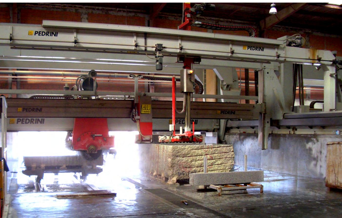
Il gruppo ventose è montato su un braccio telescopico verticale con lunga estensione. Un sistema ad argano / fune metallica permette la salita e discesa rapida e precisa, il movimento è mantenuto in sicurezza dallo speciale sistema di blocco "anticaduta".
