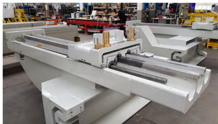
La salita e discesa del ponte è permessa da due grandi corsoi che scorrono lungo i due montanti verticali tramite l'esclusiva **combinazione a doppia vite**.
