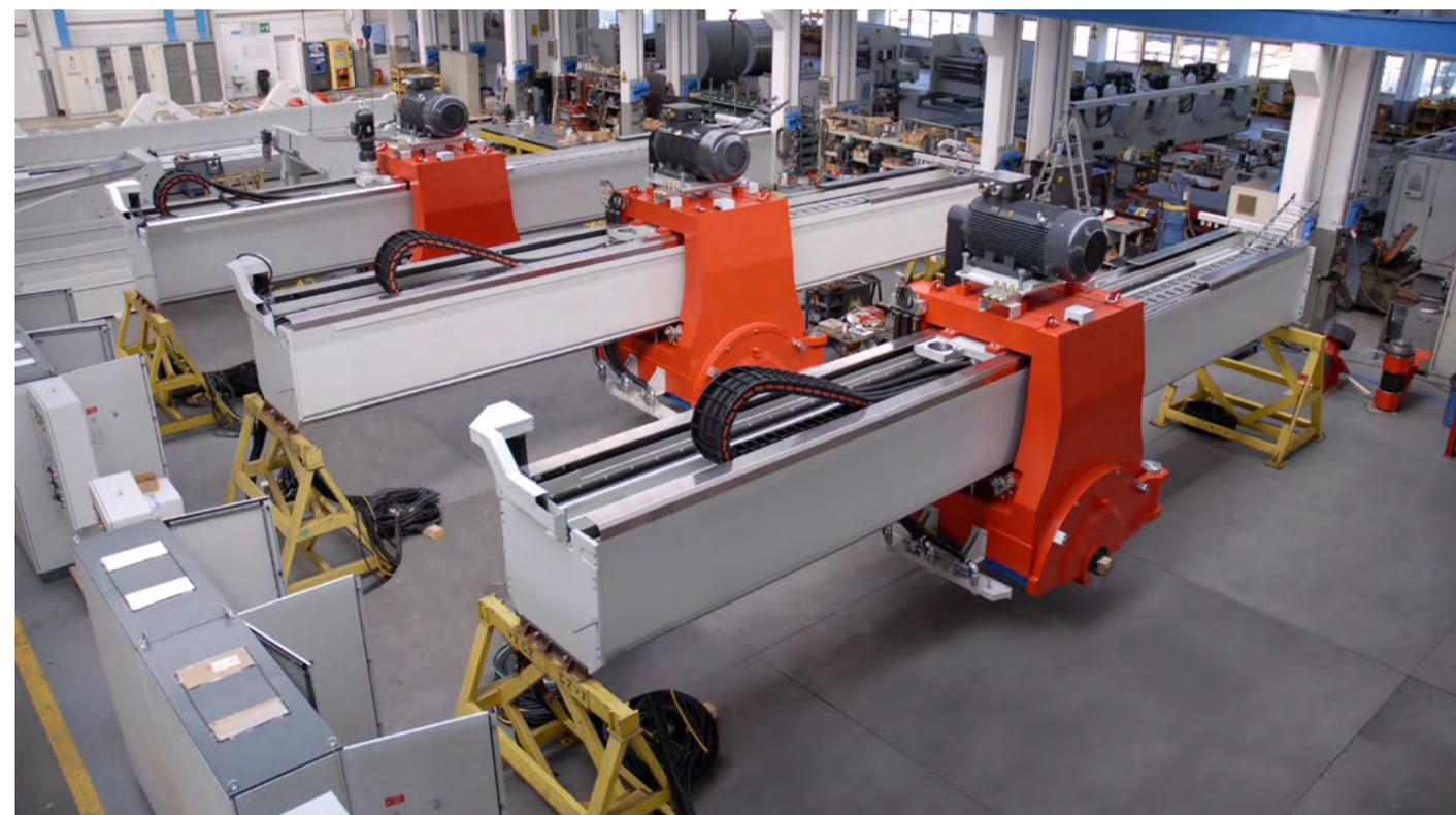
La struttura del carro portadischi è la parte più importante dell'Arco di Trionfo. Il suo scorrimento sul ponte, fluido e continuo, viene permesso dalle **speciali slitte a V** e da quattro ruote di contrasto che creano un movimento bilanciato a "gioco zero".
