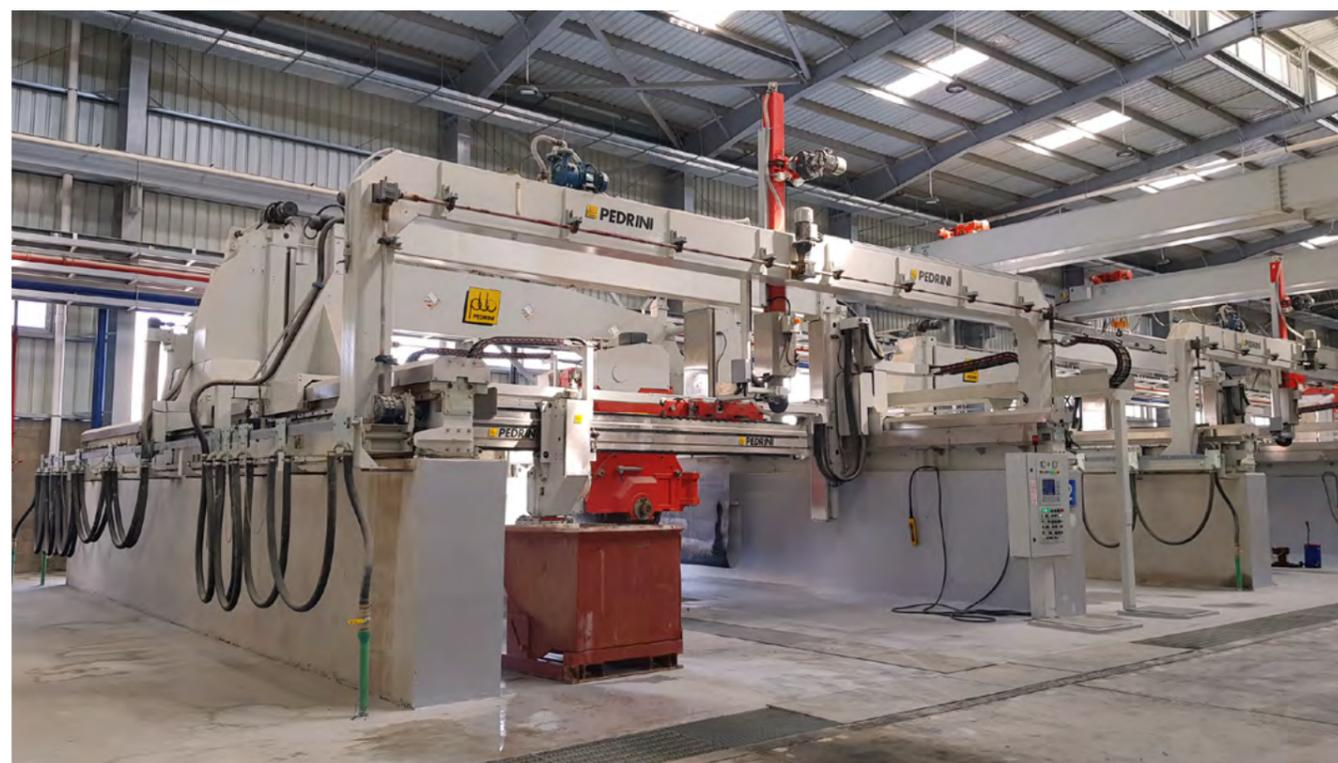
Il carrello portablocchi è costruito in carpenteria pesante ed è fornito di due ruote motorizzate e di due ruote folli.
