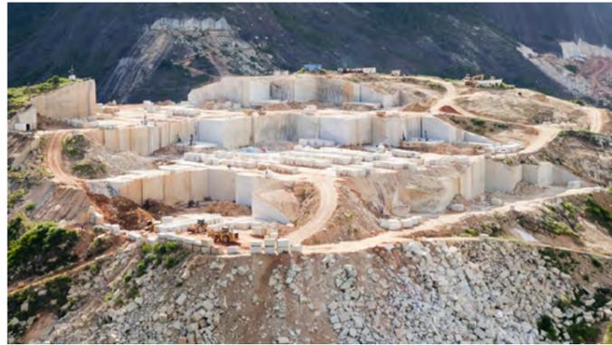
L'altezza dei blocchi per la produzione di modulgranito viene generalmente già selezionata in cava, scegliendo una dimensione che sia un multiplo dell'altezza delle filagne da ricavare.
