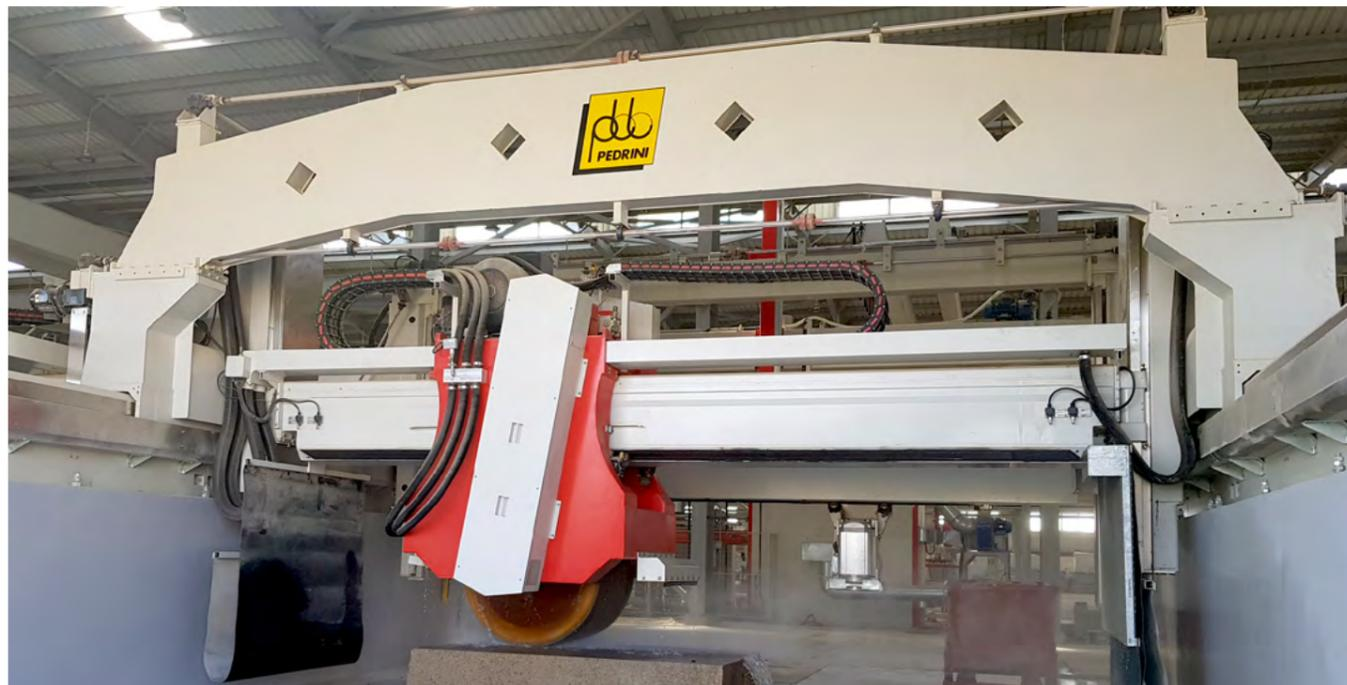
Una struttura ad "arco" collega i due moduli del movimento di salita e discesa del ponte dei dischi verticali in appoggio sulle vie di corsa.
