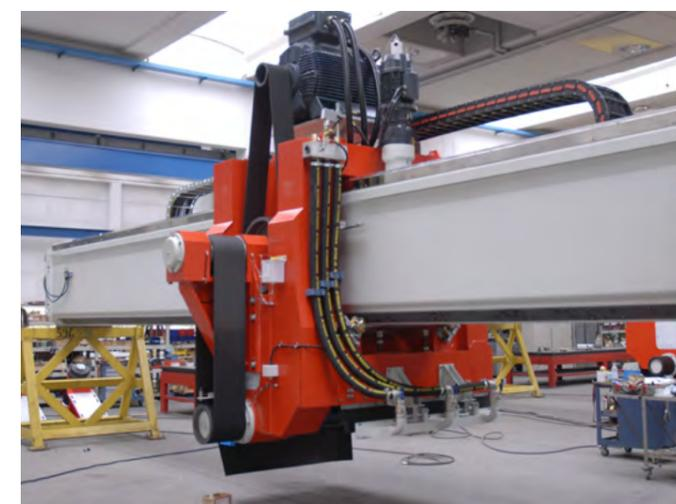
Il gruppo disco orizzontale utilizza un disco diamantato di diametro 350 mm che permette il taglio di filagne con spessore fino a 30 mm.
