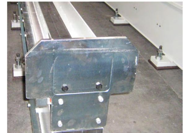
Il movimento di traslazione delle tre unità operative avviene su due traverse di scorrimento, saldamente ancorate alle fondazioni.
