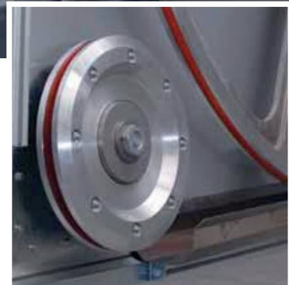
La ruota motrice è azionata da un sistema di cinghie/pulegge ed un motore controllato da inverter per gestire la velocità periferica del filo diamantato.
