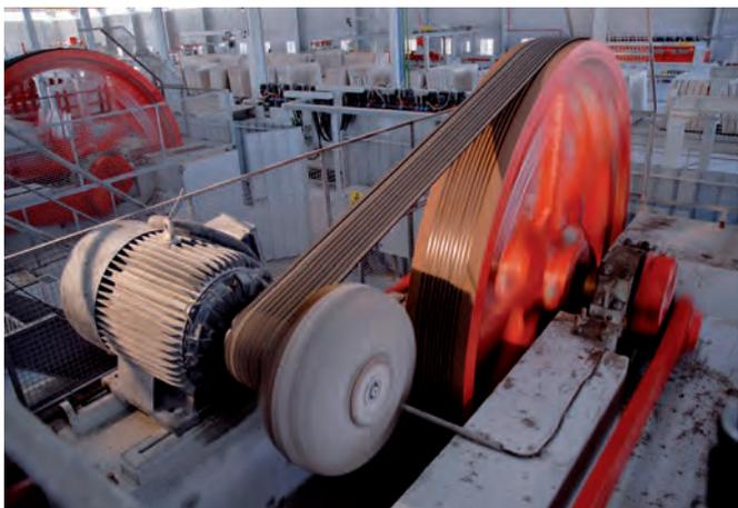
Sistema di trasmissione del volano nella versione standard gestito da motore con azionamento a stella/triangolo. La coppia di spunto viene controllata da un giunto idraulico montato sull'asse del motore principale.
