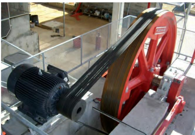
Sistema di movimentazione del volano gestito, in opzione, da motore controllato da inverter.
