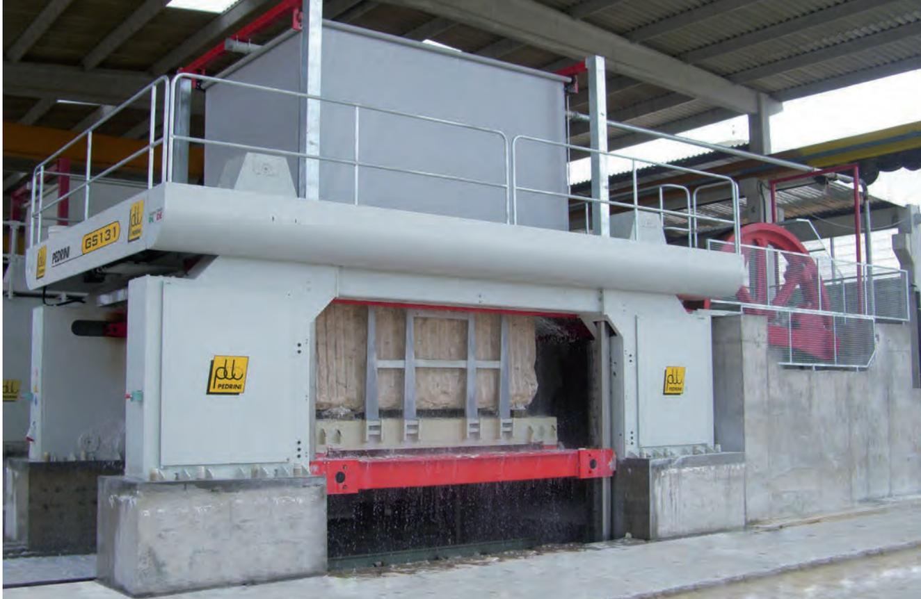
Un sistema idrico di lubrificazione delle lame è posizionato sopra la struttura del telaio, creando una pioggia che copre le dimensioni del blocco.
