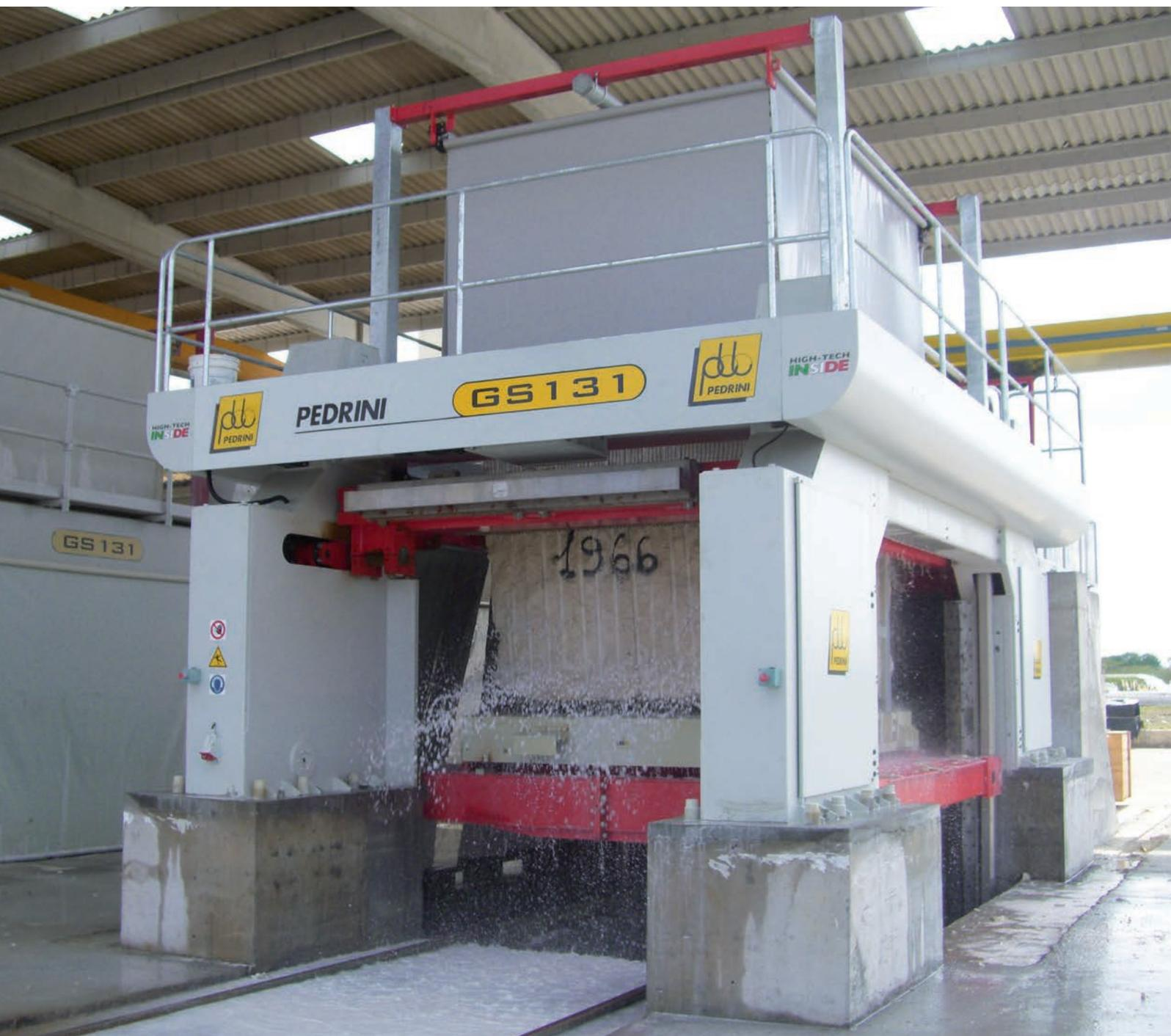
I quattro riduttori che contengono le chiocciolate sono collegati da una trasmissione diretta senza interposizione di catene, azionata da un motoriduttore per alta e bassa velocità.
