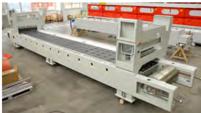
Due ponti laterali contengono gli alloggiamenti per i rulli temprati e rettificati che lavorano a bagno d'olio e permettono lo scorrimento della traslazione della trave.
