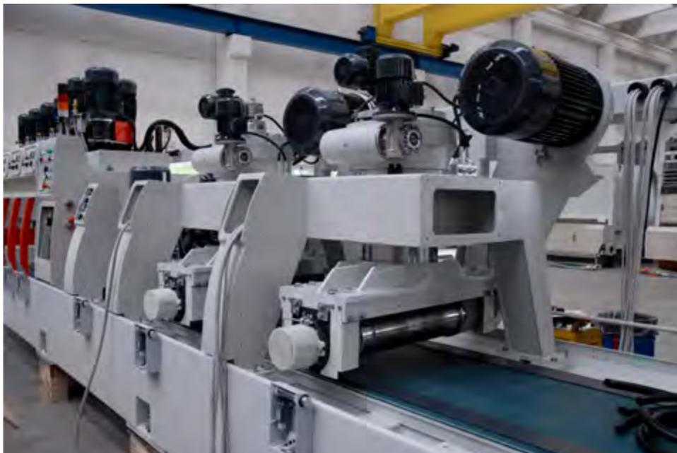
La **struttura portante dei gruppi calibratori** è realizzata in moduli per due o tre unità operative e al centro ospita un grande cilindro cromato mobile che supporta i 4 movimenti di ogni singolo calibratore:
