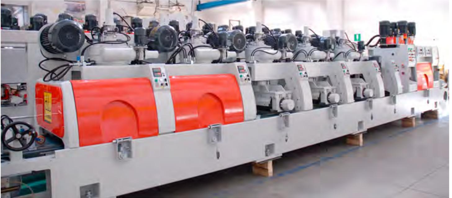
Le due unità supplementari con platorelli diamantati ad asse verticale, posizionate dopo l'ultima unità calibrante, sono regolabili in altezza e provvedono a rettificare i bordi laterali della superficie.
