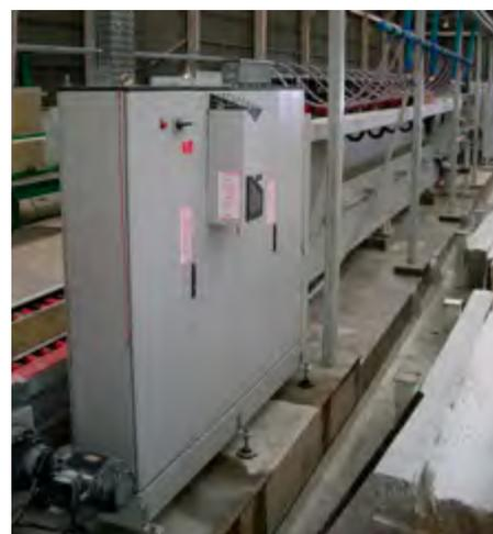
Ogni testa è fornita di un singolo pannello di comando frontale che permette i movimenti manuali di salita e discesa e la gestione della pressione pneumatica di lavoro.
