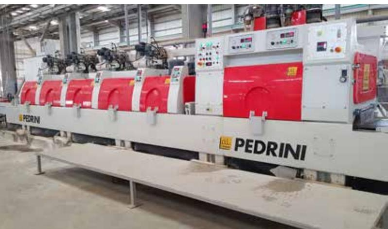
L'aggiunta di un gruppo con due o più mandrini Rotor con teste Aquila sullo stesso banco della calibratrice consente di rimuovere i segni della calibratura prima di entrare nella lucidatrice.
