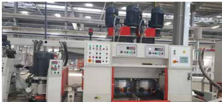
Le teste Aquila progettate da Pedrini sono equipaggiate con 5 satelliti diamantati che garantiscono un'alta capacità di asportazione.
