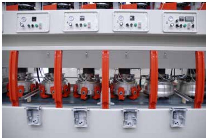
**I mandrini Rotor brevettati con funzionamento a contropressione pneumatica** sono **forniti di serie** e, nella levigatura con teste Aquila, sono dotati di **calata centesimale regolabile Smart Contact** che impedisce al mandrino di scendere sotto una quota predefinita. La contropressione rimane attiva mantenendo la sensibilità nel caso di sovramateriale.
