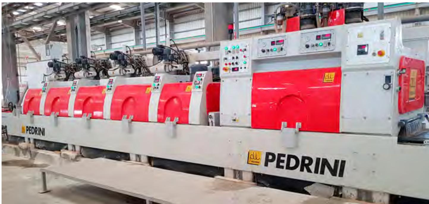
La sezione di calibratura è fornita del sistema di autoregolazione **PID (Proporzionale Integrale Derivativa)** che riduce la velocità del nastro in funzione del consumo elettrico eccessivo dei rulli calibratori.
