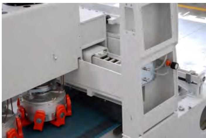
La corsa trasversale della trave viene regolata anche a macchina in movimento, agendo su un **indicatore meccanico** manuale posizionato frontalmente.
