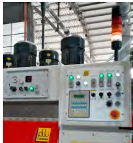
Il quadro elettrico principale di grandi dimensioni è posizionato dietro la macchina e protetto contro polvere e spruzzi d'acqua secondo IP 54 (EN 60529) ed è fornito di climatizzatore con scambiatore di calore.
