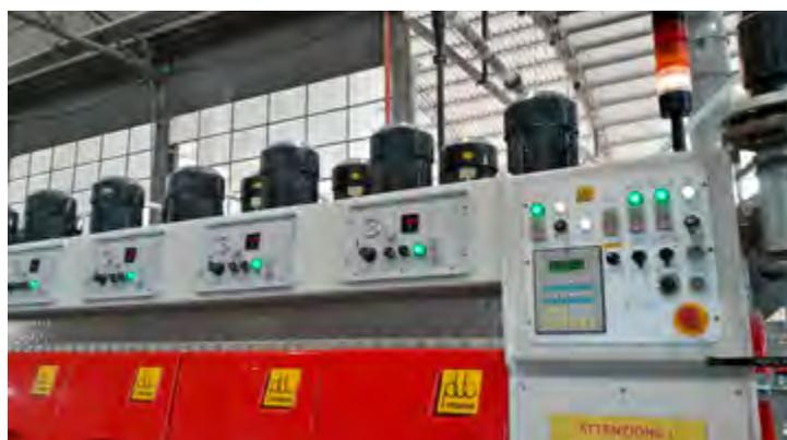
Il consumo degli abrasivi è gestito da una serie di sensori posizionati su ogni testa. Un indicatore meccanico manuale posizionato sopra la trave permette la regolazione generale in caso di cambio di spessore. Ad abrasivi consumati la singola testa si ferma automaticamente e si esclude alzandosi.
