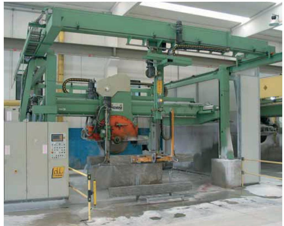
■ I parametri di taglio vengono impostati sulla tastiera. Posizionamenti e parametri sono visualizzati in tempo reale su display e i cicli di lavoro sono controllati dal PLC
