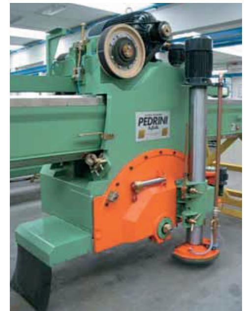
Le traverse alloggiano le guide e i pattini per lo scorrimento trasversale del ponte. Il movimento è comandato da due sistemi sincronizzati vite/ chiocciola che operano in bagno d'olio e sono protetti da carterature fisse in acciaio inossidabile.
