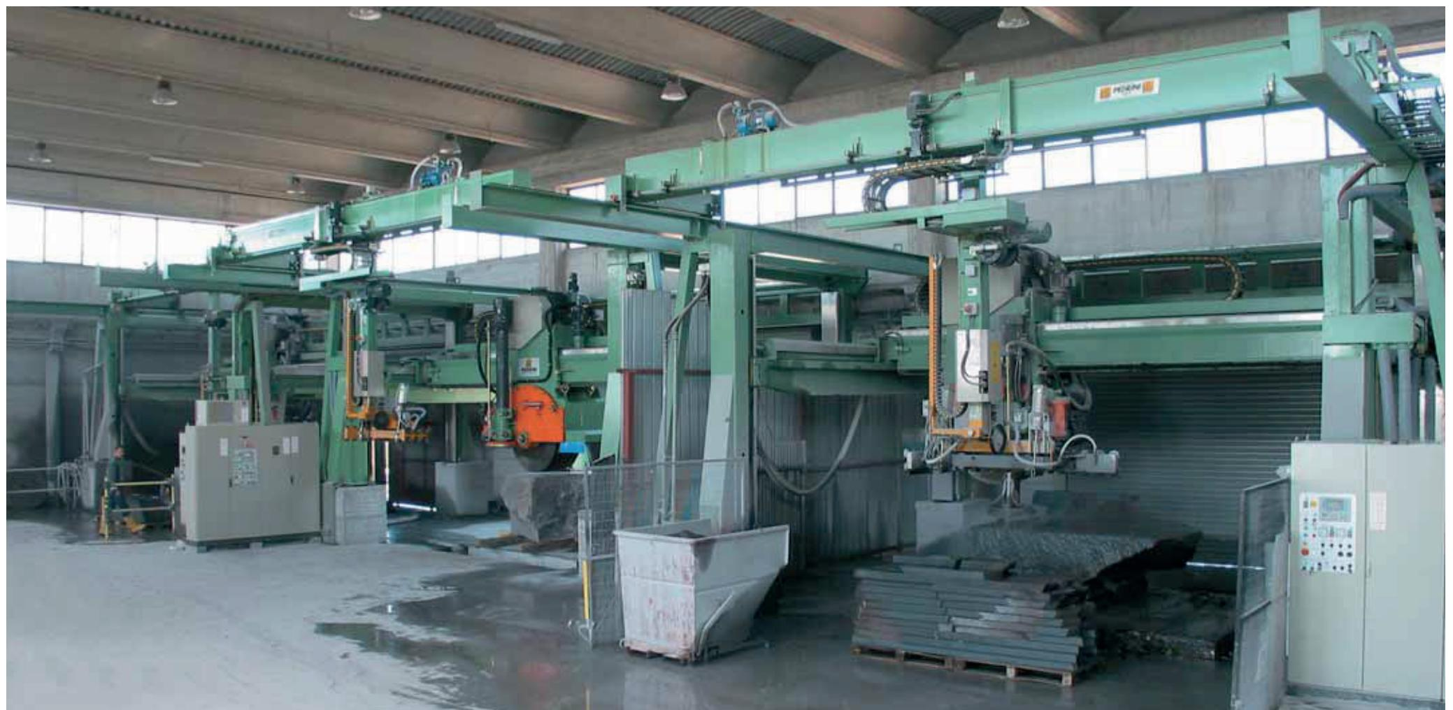
■ Il moto dal motore principale al mandrino viene trasmesso con puleggi e cinghie dentate tramite un albero di rinvio.
