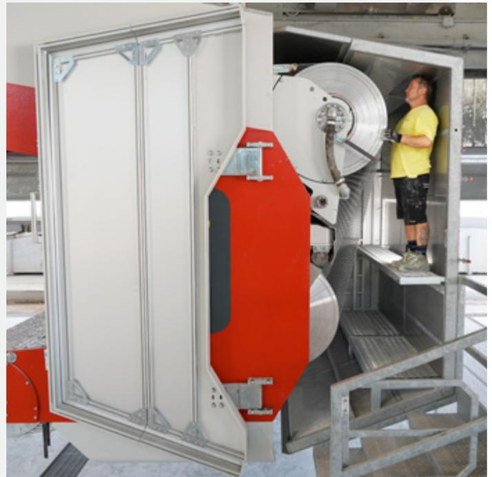
**IT** Due ampie porte permettono il facile accesso dell'operatore durante il montaggio e smontaggio dei fili diamantati. Apposite scalette sono state installate per facilitare l'accesso quando la macchina è in posizione bassa per il cambio fili.
