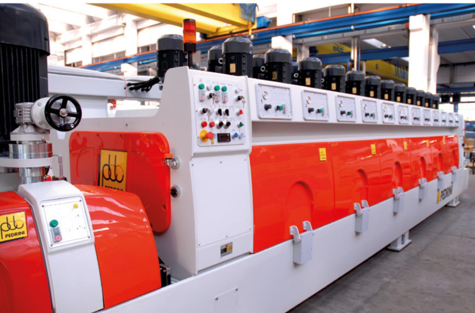
**IT** Ogni elemento operativo delle macchine **SUPERNOVA-M** è fornito di un singolo pannello di comando per le operazioni manuali e per il controllo del funzionamento.
