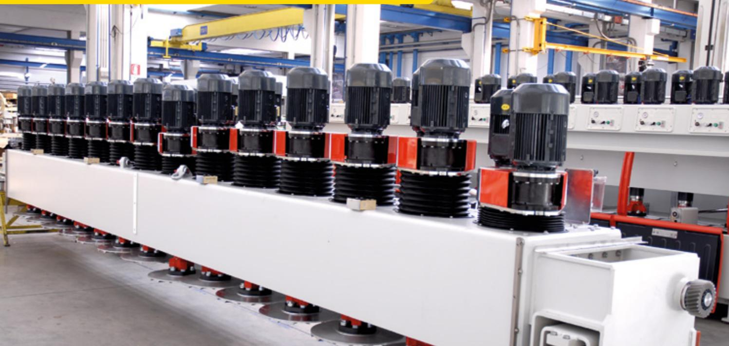
**IT** La trave mobile che alloggia i mandrini ROTOR è realizzata in corpo unico di carpenteria pesante normalizzata con struttura molto rigida.
