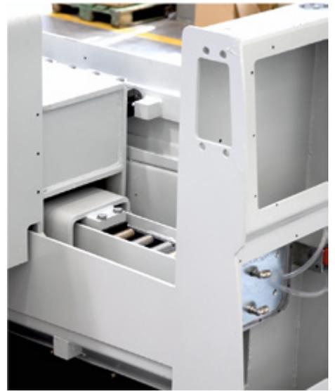
**IT** Due ponti laterali contengono gli alloggiamenti per i rulli temprati e rettificati che lavorano a bagno d'olio e permettono lo scorrimento della traslazione della trave. Gli alloggiamenti sono protetti da carter fissi a labirinto e sono dotati di sistemi per il controllo del livello dell'olio e per il drenaggio.
