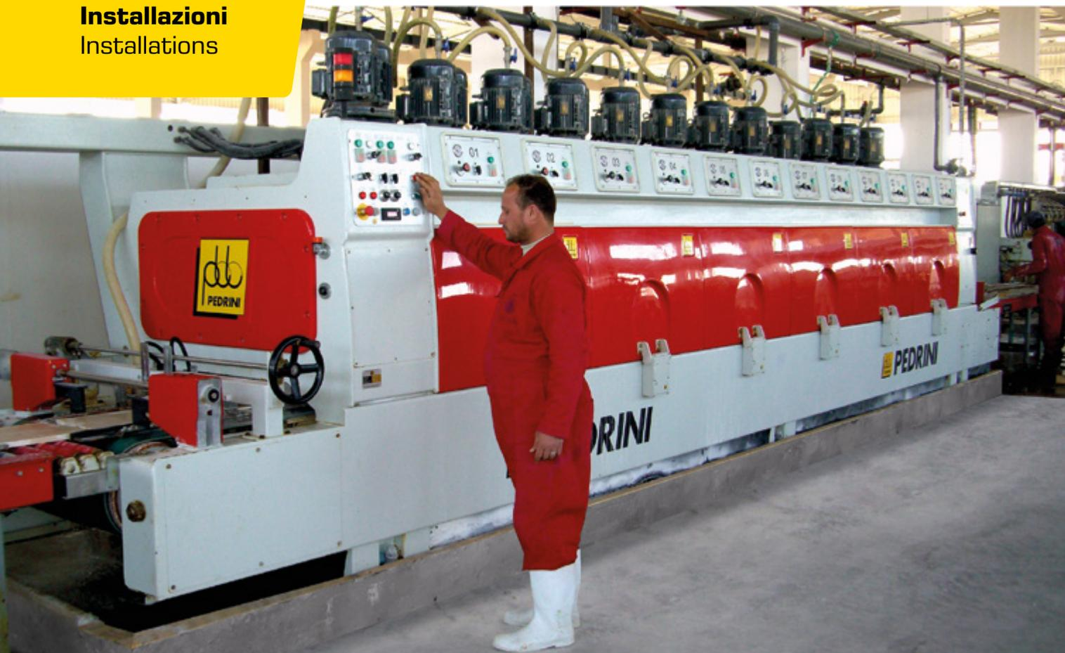
**IT** Le macchine di calibratura, levigatura e lucidatura **SUPERNOVA-M** sono potenziate con tecnologie esclusive, assicurano le massime velocità produttive con la contemporanea riduzione di consumi, manutenzione e ammortamento.
