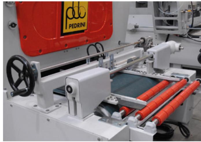
**IT** Il **nastro trasportatore** multi-tela è comandato da un rullo motrice azionato da motoriduttore epicicloidale mentre un secondo rullo folle è dotato del dispositivo di tensionamento.
