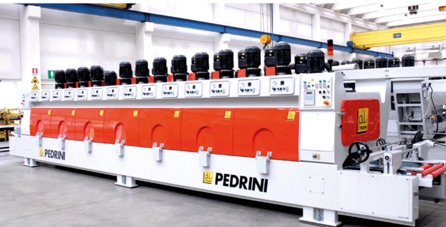
**IT** Il controllo del consumo degli abrasivi è gestito da una serie di sensori posizionati su ogni testa. Un indicatore meccanico manuale posizionato sopra la trave permette la regolazione generale in caso di cambio di spessore. Ad abrasivi consumati la singola testa si ferma automaticamente e si esclude alzandosi.
