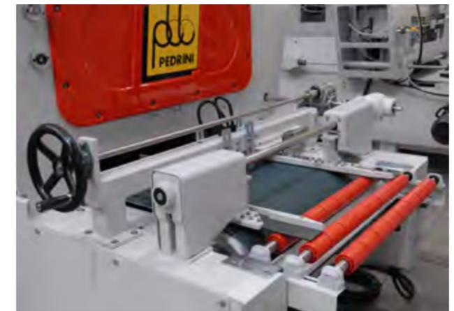
Il **nastro trasportatore** multi-tela è comandato da un rullo motrice azionato da motoriduttore epicicloidale mentre un secondo rullo folle è dotato del dispositivo di tensionamento.
