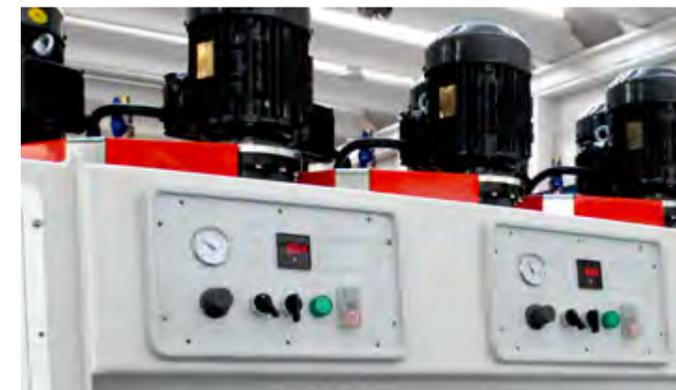
Il controllo del consumo degli abrasivi è gestito da una serie di sensori posizionati su ogni testa. Un indicatore meccanico manuale posizionato sopra la trave permette la regolazione generale in caso di cambio di spessore. Ad abrasivi consumati la singola testa si ferma automaticamente e si esclude alzandosi.
