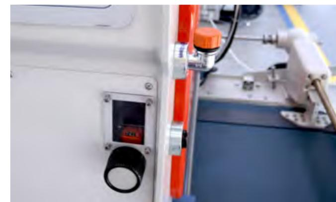
La corsa trasversale della trave viene regolata anche a macchina in movimento, agendo su un indicatore meccanico manuale posizionato frontalmente sulla macchina.
