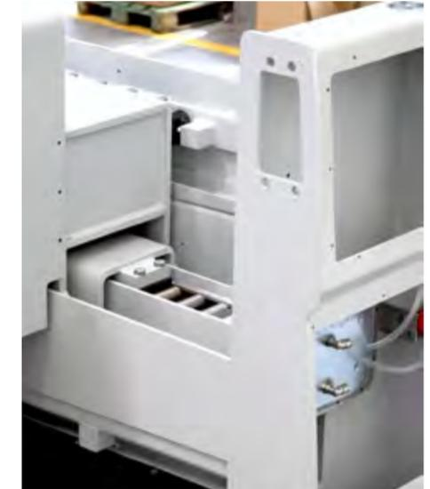
Due ponti laterali contengono gli alloggiamenti per i rulli temprati e rettificati che lavorano a bagno d'olio e permettono lo scorrimento della traslazione della trave.
