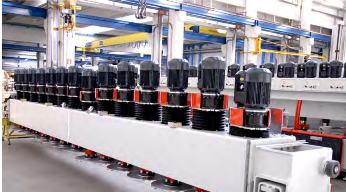
La trave mobile che alloggia i mandrini ROTOR è realizzata in corpo unico di carpenteria pesante normalizzata con struttura molto rigida.
