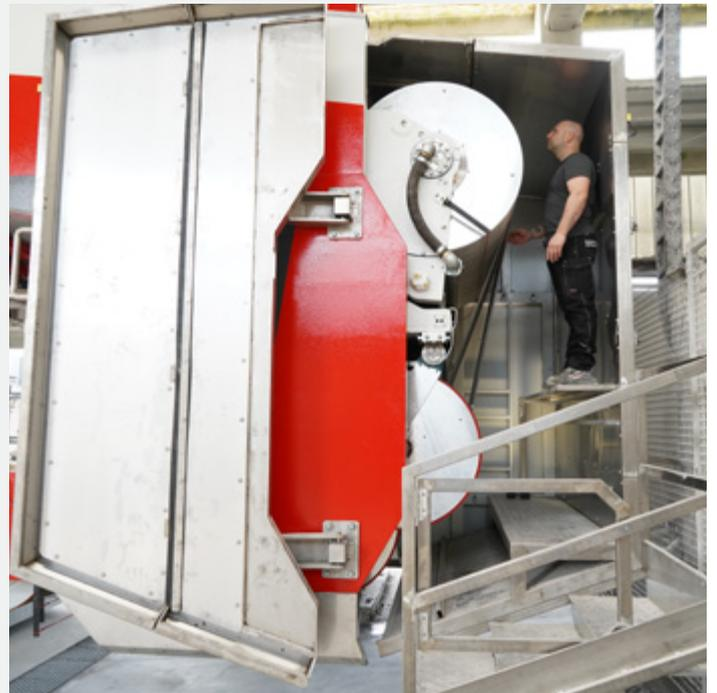
**IT** Due ampie porte permettono il facile accesso dell'operatore durante il montaggio e smontaggio dei fili diamantati. Apposite scalette sono state installate per facilitare l'accesso quando la macchina è in posizione bassa e si opera il cambio fili.
