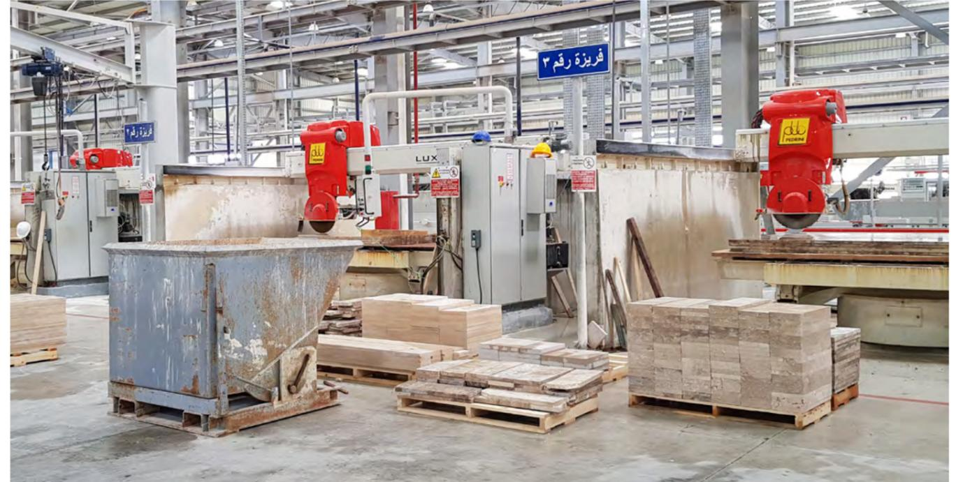
La struttura della M920 è composta principalmente da un ponte e da un carro mobile porta-disco. Due traverse di traslazione del ponte sono fissate su muri in cemento.
