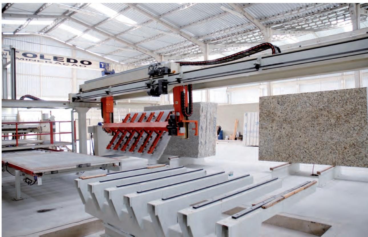
Il piano porta ventose può ruotare di 180° perciò, quando equipaggiato con una rulliera motorizzata a pettine montata su supporto rotante, BUTTERFLY B416 può eseguire la lavorazione a macchia aperta, l'allineamento delle lastre sulla linea e la ricomposizione del blocco allo scarico.
