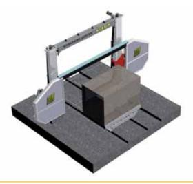
Bifilo composta da una monofilo fissa e una monofilo mobile con carrello portablocchi motorizzato e girevole.
